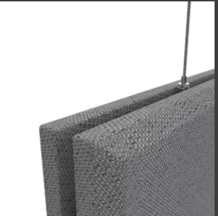
Baffel mit eckiger Kantenführung (20 mm Fase), Nut ohne Abdeckung, werkzeuglos höheneinstellbare Seil-aufhängung baffle in Lucia fabric with square edges ( 20 mm chamfer), groove without cover, tool-free height-adjustable rope suspension
